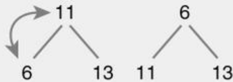
(d) Rebuild heap
