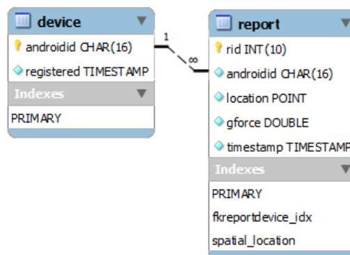
Figure 2: Database ER Diagram
